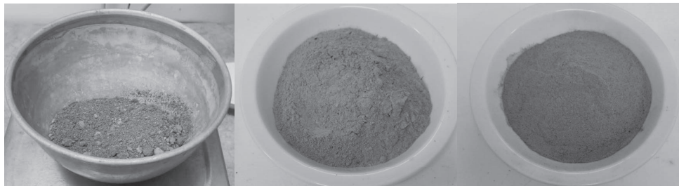
Slika 2. Uzorci pepela iz drvene biomase: a) pepeo s dna peći; b) leteći pepeo finije frakcije; c) leteći pepeo krupnije frakcije
