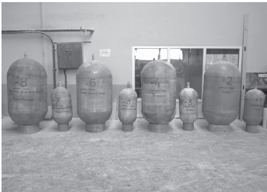
Slika 4. Posude od kompozitnih materijala prije testiranja
